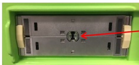
Figura 7: Muesca de bloqueo de la ranura de conexión del transductor
